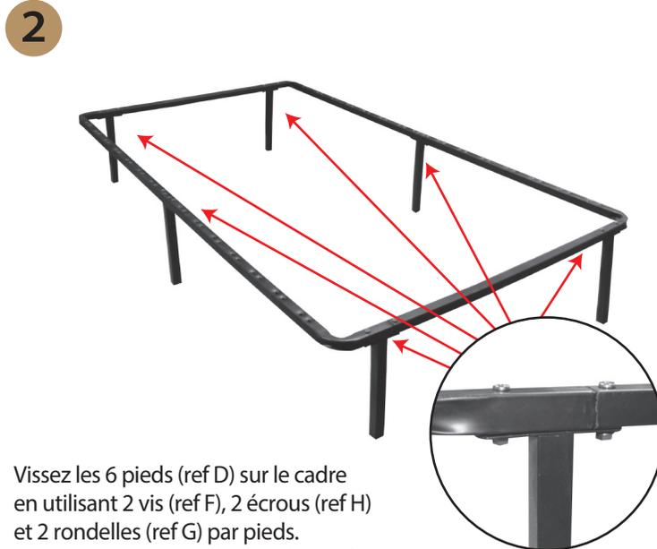
Vissez les 6 pieds (ref D) sur le cadre en utilisant 2 vis (ref F), 2 écrous (ref H) et 2 rondelles (ref G) par pieds. Resserrez en utilisant la clé Allen (ref I) et la clé plate (ref J).
