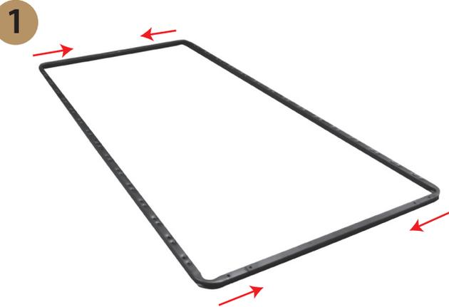
Avec les trous vers le haut, insérez les rail côté (ref A) dans les rails tête et pieds (ref B)
